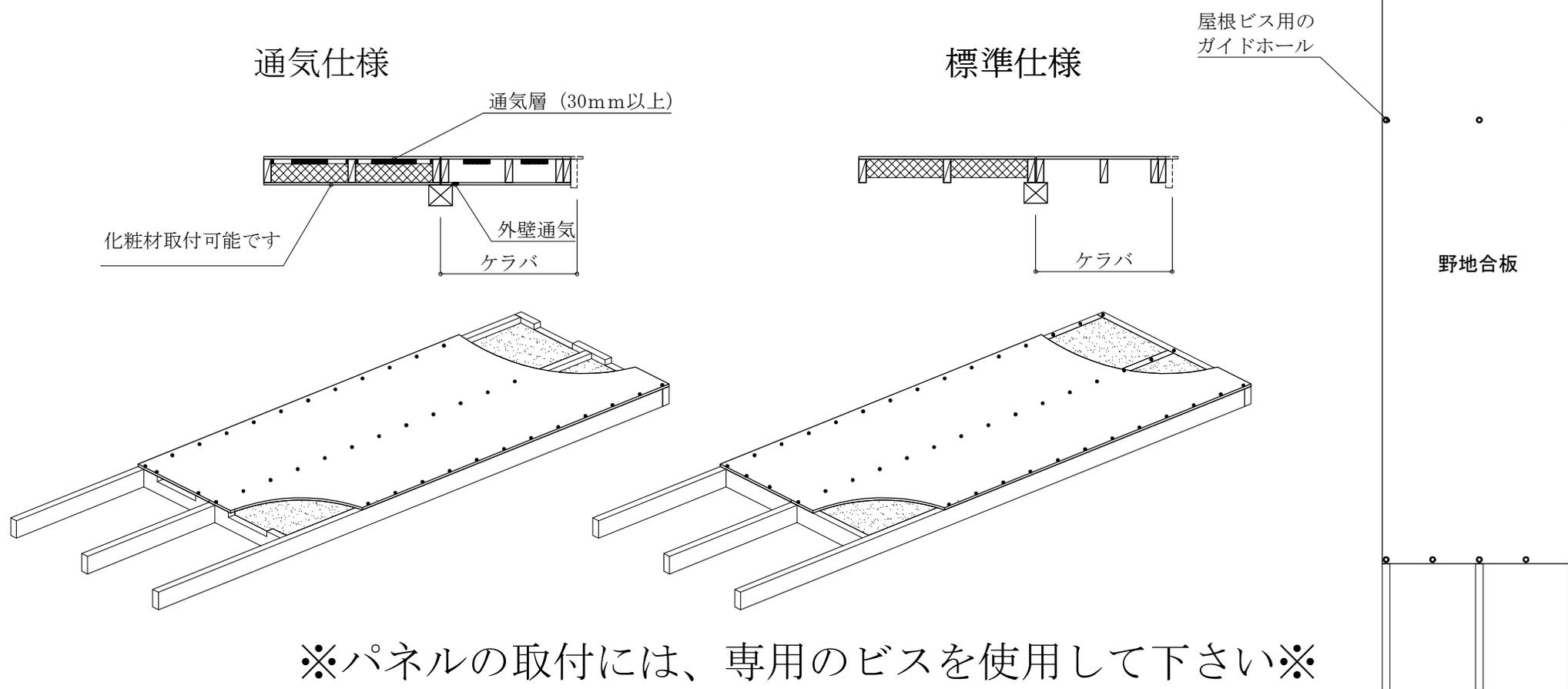
※パネルの取付には、専用のビスを使用して下さい※
